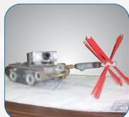
Les différents types et formats de brosses rotatives activées à l'air comprimé reliées à un robot télécommandé, détachent les contaminants des parois des conduits. Un collecteur de résidus relié au conduit capte toutes les poussières, saletés et polluants pendant l'exécution des travaux.
